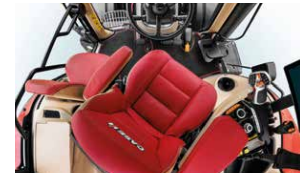
LE SIÈGE PIVOTANT S'ORIENTE JUSQU'À 40°, OFFRANT UNE VUE DÉGAGÉE SUR LES OUTILS ARRIÈRE ET UN PLUS GRAND CONFORT PENDANT LES LONGUES JOURNÉES DE TRAVAIL.
