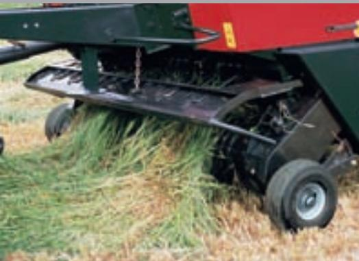
Optional ist für den Standard- Niederhalter der Pick-up ein Rollenniederhalter verfügbar. Unter gewissen Erntebedingungen, wie z.B. große und schwere Schwaden, stellt der Rollenniederhalter einen gleichmäßigeren Gutfluss zum Rotor sicher.
