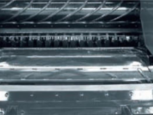
*Der Kettenelevator sorgt für eine schlupffreie Bewegung des Ernteguts beim Pressvorgang.*
