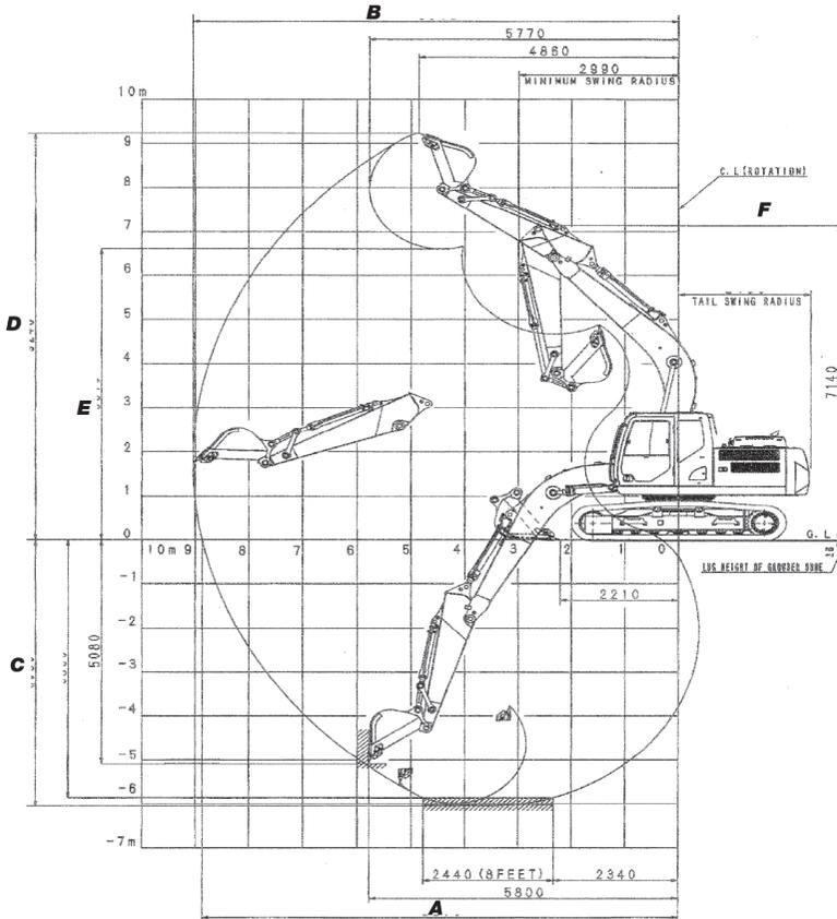
ALCANCE DE EXCAVACIÓN CON BRAZO HD 3,05 M (10')
