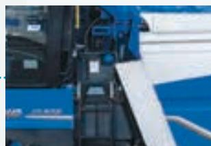
Les réservoirs de carburant et d'AdBlue peuvent être remplis depuis l'échelle pour simplifier l'accès.
