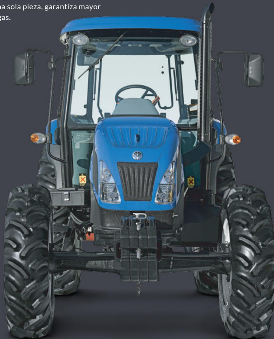
Dado que la TDF del TL5 tiene un acoplamiento progresivo y es independiente, se elimina la necesidad de detener el tractor para su activación. Además de la velocidad estándar de 540 rpm, se ofrece una opción económica y un sistema de velocidad sincronizada con las ruedas. Si se activa la marcha atrás, esta sincronización permite que se invierta el sentido de torsión del eje de la toma de fuerza, lo que facilita el desenganche de implementos como la picadora de forraje.
