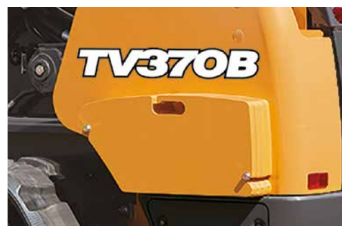
Dodatkowa przeciwwaga zwiększająca udźwig.
