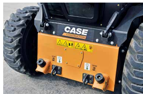
Wsporniki podwozia wspierające siłę pchania maszyny!
