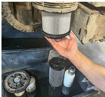
Frische Hydraulikfilter – große Wirkung auf Lebensdauer und Wartungskosten.
