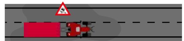
**THE ADVANCED TRAILER BRAKE SYSTEM ACTIVELY STABILISES THE TRACTOR AND TRAILER COMBINATION BY USING THE TRAILER'S BRAKES.**
