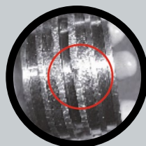
DANNO AL PISTONE DELLA POMPA
