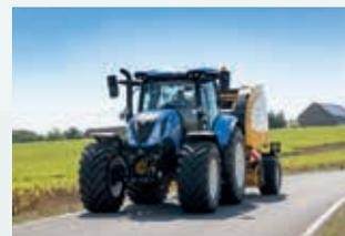
Pneus ultra largos 500/55-R20 reduzem a compactação para facilitar o novo crescimento para cortes de silagem subsequentes. Também proporcionam um transporte mais confortável em estrada.
