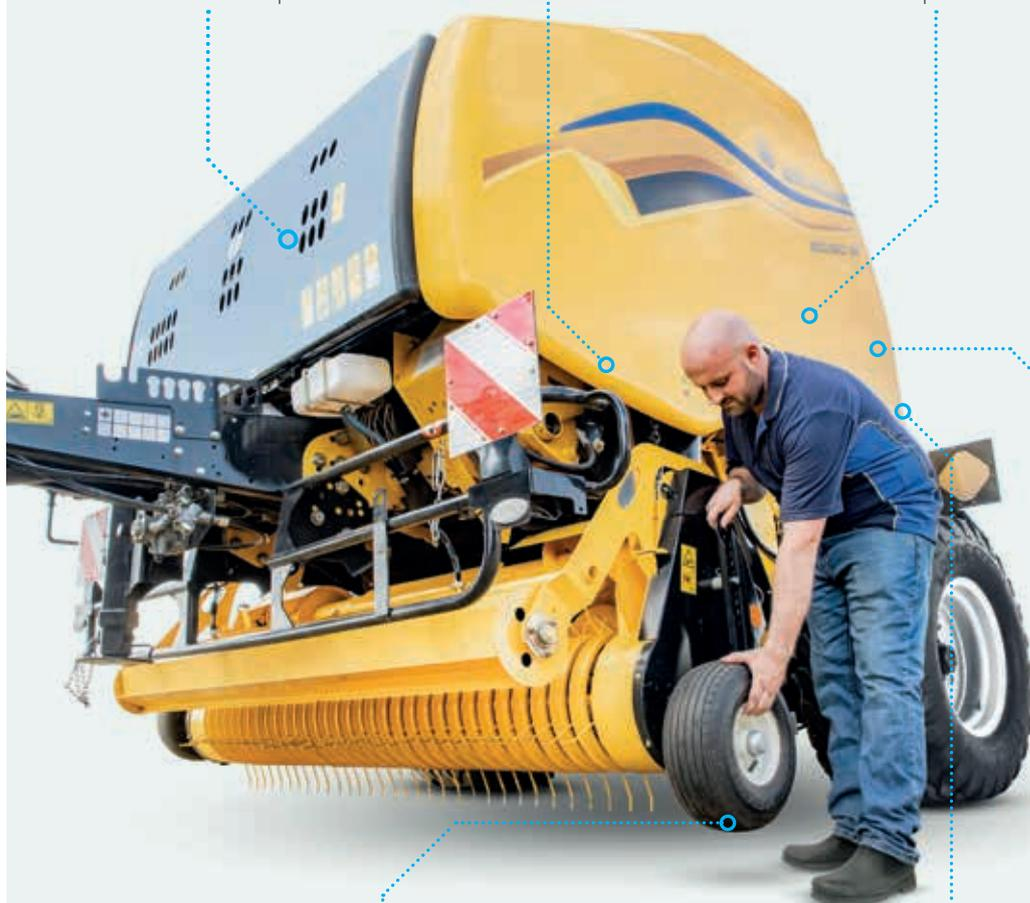
As rodas articuladas do pick-up mudam do modo de campo para o modo de transporte sem ser necessário utilizar ferramentas.
