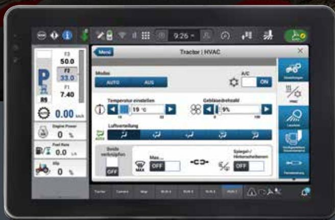
Die neue HVAC-Klimaanlage mit Druckbeaufschlagung verfügt über mehr Lüftungsöffnungen und Lamellen, um den Luftstrom um den Fahrer zu verstärken. Es kann auch direkt über den Encoder oder die konfigurierbaren Tasten gesteuert werden.
