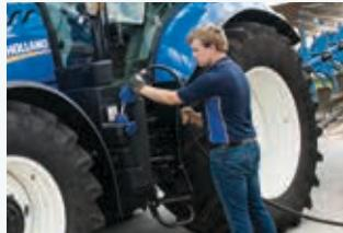
L'orifice de remplissage du réservoir d'AdBlue de 48 litres est plus étroit que celui du réservoir à carburant, ce qui évite de le remplir par inadvertance avec du carburant. Le plein du réservoir se fait tous les deux pleins de carburant.
