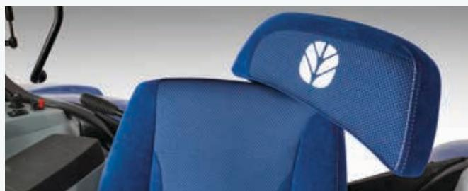
La plupart des sièges sont équipés d'un dossier pivotant innovant pour soutenir la partie supérieure du dos et améliorer nettement le confort lorsque le siège est tourné vers l'arrière pour surveiller les outils.
