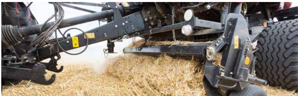
Strängläggning av kort eller lång halm för perfekt formade balar
