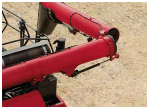
Tömningsrör på 8,8 m och 10,4 m finns tillgängliga i ett fällbart utförande, vilket ger enklare vägtransport och enklare manövrering i maskinhallen.
