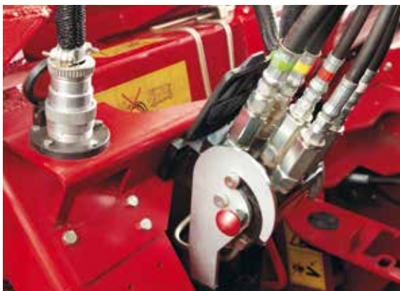
Montera skärbordet på några minuter med ett enkelt reglage som kopplar hydraul- och elfunktioner
