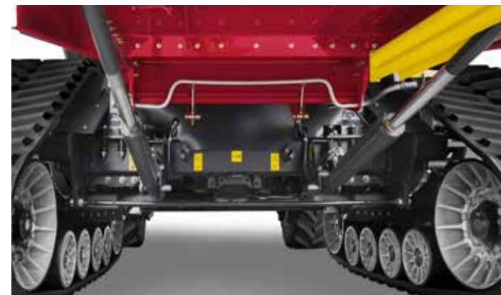
Förskjutna lyftcylindrar för högre lyftkapacitet. Dubbla lyftcylindrar för förbättrad styrning av skärbordshöjden
