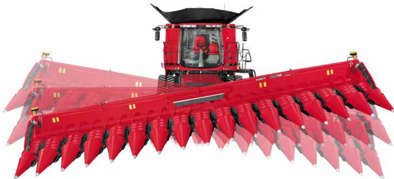
Case IH:s Terrain Tracker-teknik säkerställer att exakt snitthöjd bibehålls över ojämna fält.
