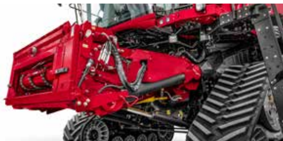
Framåt- och bakåttilt för att ställa in skärbordets vinkel – all liggande gröda tas om hand utan spill
