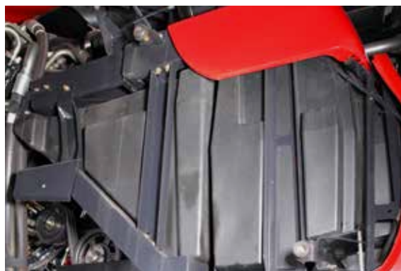
Bränslekapacitet på 1 125 liter (7250, 8250) eller 1 200 liter (9250) för långa arbetsdagar. När den är utrustad med Xtra-Chopping-hacken har 9250-modellen en kapacitet på 1 020 liter
