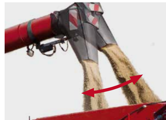
Tillvalet vridbart utblåsningsrör manövreras med multifunktionsreglaget, riktar spannmålet till spannmålsvagnen och fyller den helt utan spill.
