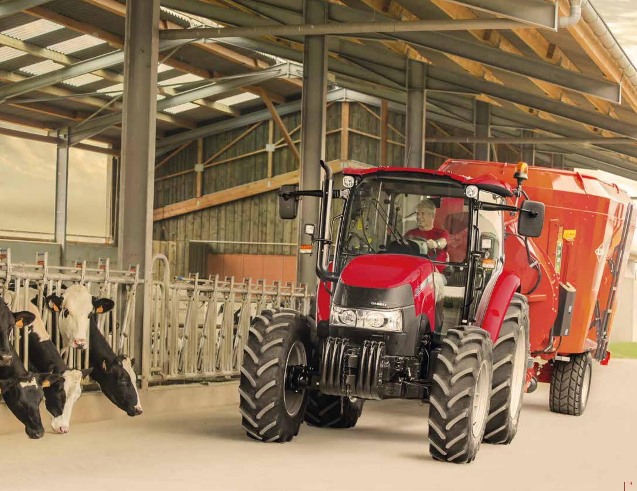
Le relevage avant électronique (EFH) vous permet de tirer le meilleur profit des outils frontaux. Il met automatiquement l'outil avant à la hauteur préréglée et maintient sa pression au sol constante. Cela permet de contrôler l'outil plus précisément dans de nombreuses applications, comme les travaux de fauche, par exemple.
