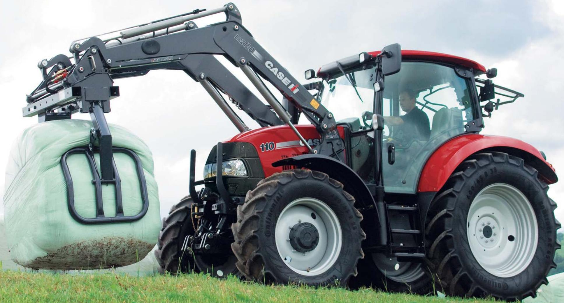
► **Beste Sicht.** Neue Z-Kinematik zur Parallelführung im Schwingenholm, geschützte Leitungen und Hydraulikventilblock in Modulbauweise sorgen für freie Sicht.
