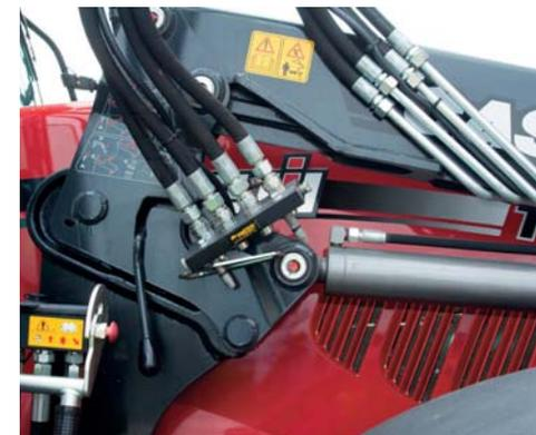
► **3. und 4. Steuergerät** für den Betrieb
