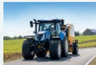
Optionale Breitreifen 500/55-R20 für weniger Bodenverdichtung: besseres Nachwachsen von Siliergut. Sie sorgen außerdem für mehr Komfort im Straßeneinsatz.
