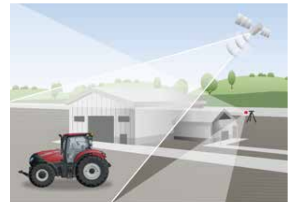
xFill bevarer forbindelsen ved RTK+ signaltab i op til 20 minutter
