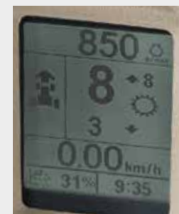
PUMA MULTICONTROLLER MODELLER: DET VALGTE OMRÅDE OG GEAR VISES TYDELIGT PÅ A-STOLPENS DISPLAY
