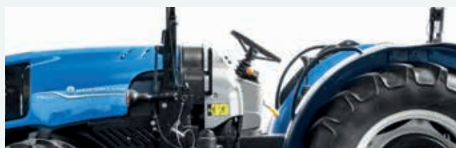
Überrollbügel mit Gasdruckfeder im Zwischenachsbereich speziell für den Obstanbau
