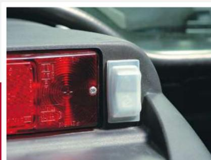
▲ Los controles del elevador montados en el guardabarros permiten acoplar los equipos e implementos de forma fácil y segura.
