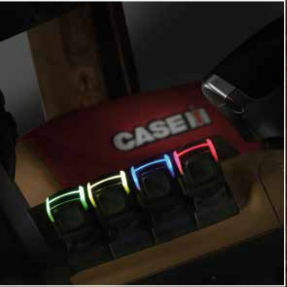
LAS LEVAS DE CONTROL CONFIGURABLES CON CAMBIO DE COLOR EN EL APOYABRAZOS PERMITEN LA ASIGNACIÓN DE LOS MANDOS A DISTANCIA TRASEROS.
