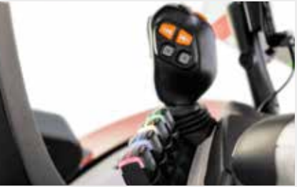
EL JOYSTICK OFRECE UN CONTROL PRECISO DE LOS ELEVADORES TRASERO Y DELANTERO, PARA UNA LABOR MÁS SUAVE.
