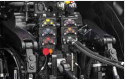
LOS MANDOS A DISTANCIA ELECTROHIDRÁULICOS PROPORCIONAN UN MAYOR CAUDAL Y UNA RESPUESTA MÁS RÁPIDA, JUNTO CON UNA MAYOR DURABILIDAD.
