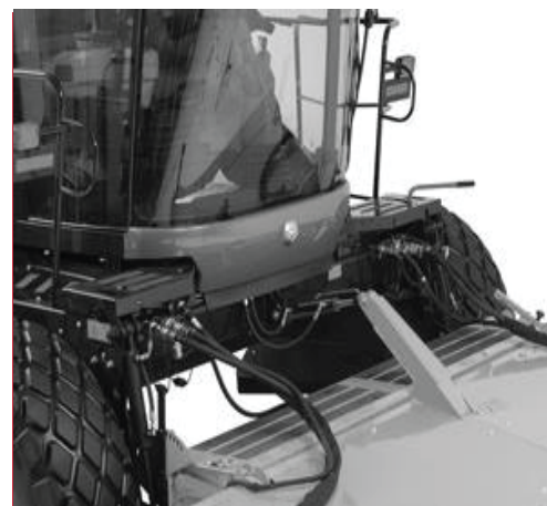
Conexión del cabezal en modelos anteriores
