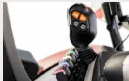
IL JOYSTICK OFFRE UN CONTROLLO PRECISO IN PUNTA DI DITA DELLE FUNZIONI DELL'ATTACCO ANTERIORE E POSTERIORE – PER UN FUNZIONAMENTO PIÙ FLUIDO.
