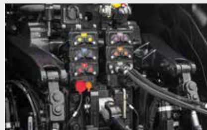
I NUOVI DISTRIBUTORI AUSILIARI ELETTROIDRAULICI OFFRONO UN FLUSSO PIÙ ELEVATO E UNA RISPOSTA PIÙ RAPIDA, CON UNA MAGGIORE DURATA.
