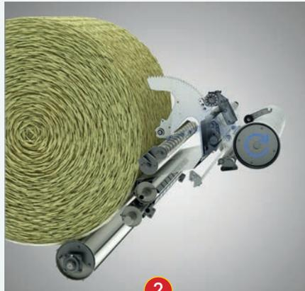
Une fois que l'emballage par fil a été réalisé sur la balle, le bec de canard revient en position de départ et le fil est envoyé dans la chambre.
