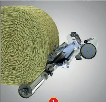
Le cycle d'emballage commence automatiquement lorsque la balle atteint sa taille maximale et que le bec de canard pivote dans la chambre, plaçant le fil sur la surface de la balle.
