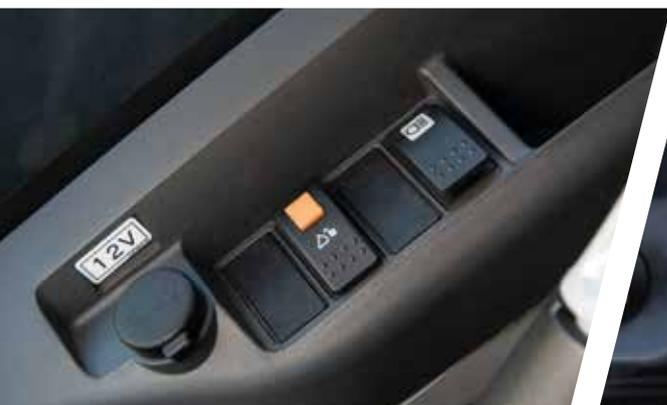
Commutateur dé verrouillage de l'attache rapide hydraulique
