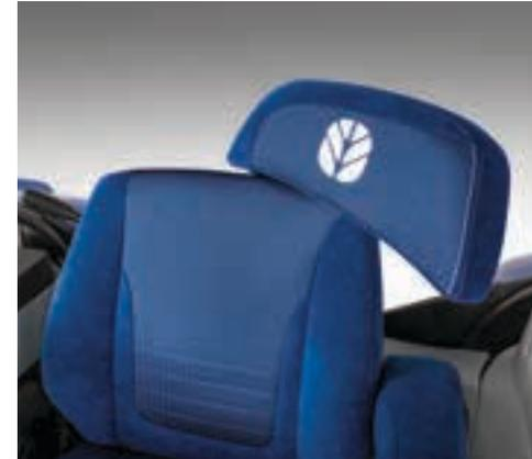
Sowohl Auto Comfort™- und der Dynamic Comfort™- als auch der Comfort-Sitz verfügen über eine Schwenkfunktion, die der oberen Rückenpartie zusätzlichen Halt gibt und den Komfort erheblich verbessert, wenn der Sitz gedreht ist, um die Heckanbaugeräte zu kontrollieren.
