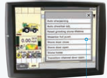
Automatyczna regulacja stalnicy z kabiny
