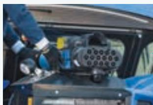
Il controllo, la pulizia o la sostituzione del filtro dell'aria del motore non richiedono alcun tipo di utensile e tutte queste operazioni possono essere facilmente eseguite da terra.
