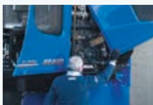
Il cofano motore in due pezzi è completamente apribile per la massima assistibilità: il frontale si ribalta perfettamente per consentire l'accesso al vano motore, mentre il portellone laterale scorre facilmente grazie all'ammortizzatore a gas, facilitando la pulizia e la manutenzione dell'impianto idraulico e dei radiatori.
