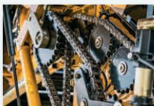
Trasmissione più robusta - nuovo riduttore e nuove catene di trasmissione.
