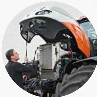
Il cofano motore monopezzo, ammortizzato, può essere sollevato (45°/90°), anche con l'attrezzo anteriore montato.
