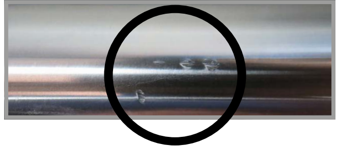
PISTÓN CON CONTAMINACIÓN DE PARTÍCULAS
