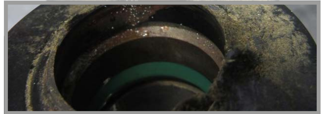
PISTÓN CON CONTAMINACIÓN DE PARTÍCULAS
