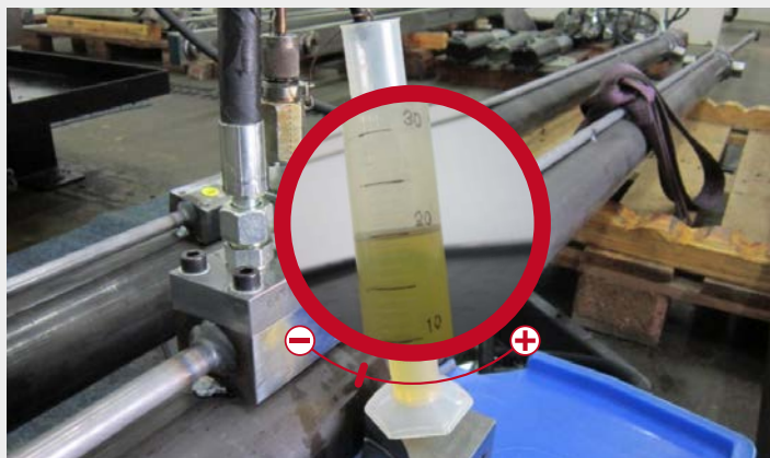
Test wewnętrznych i zewnętrznych wycieków
