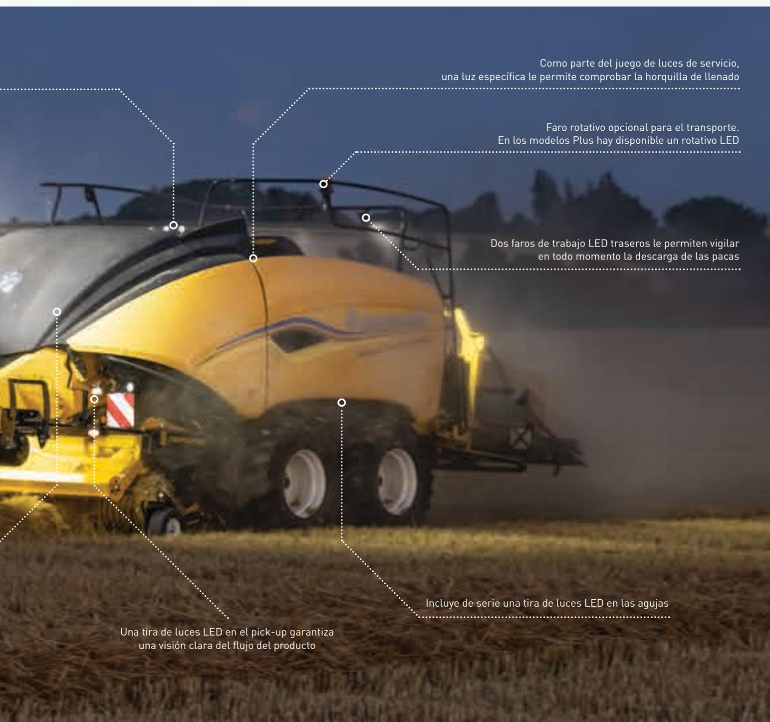
Como parte del juego de luces de servicio, una luz específica le permite comprobar la horquilla de llenado
