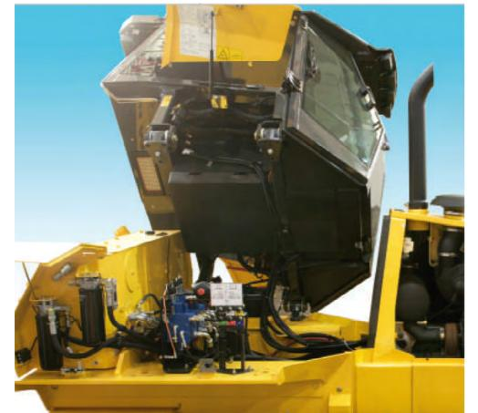
El nuevo D150B incluye una cabina que puede ser completamente inclinada hacia el lado izquierdo, lo que da un acceso sin precedentes a todos los componentes del tren de potencia. Además, la función de inclinación es controlada por una bomba hidráulica manual, para conveniencia del operador o mecánico. El resultado son verificaciones y reparaciones rápidas y seguras, cuando sean necesarias.
