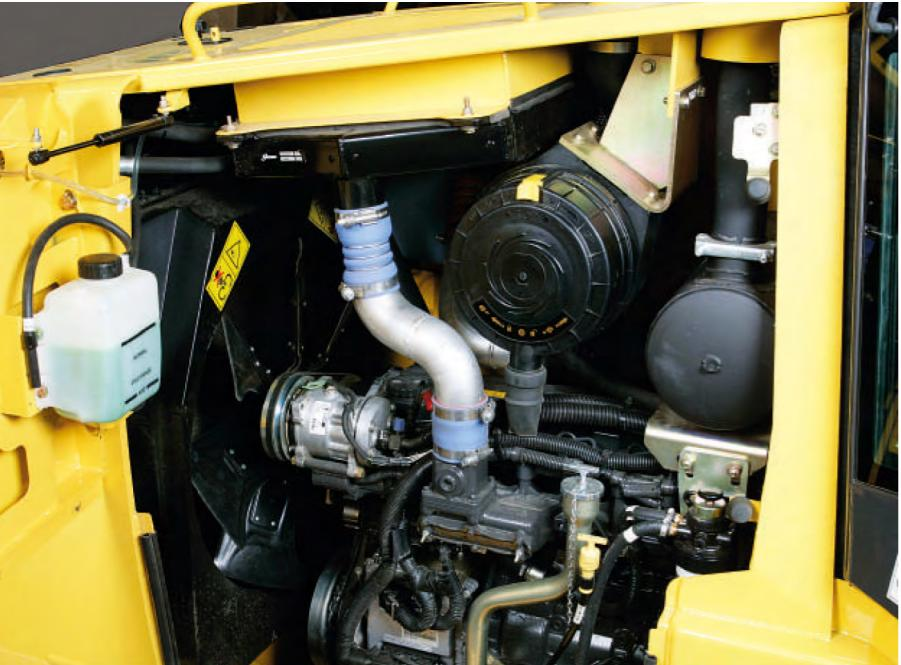
El nuevo motor New Holland Common-Rail, de alta tecnología, fue diseñado para desarrollar potencia y par elevados y para proporcionar una reducción en el consumo de combustible y en la emisión de contaminantes. Genera una potencia 12% mayor con la misma rotación del cigüeñal (2.200 rpm) y un aumento de par máximo de 690 Nm (comparado con los 60 Nm del modelo anterior).
