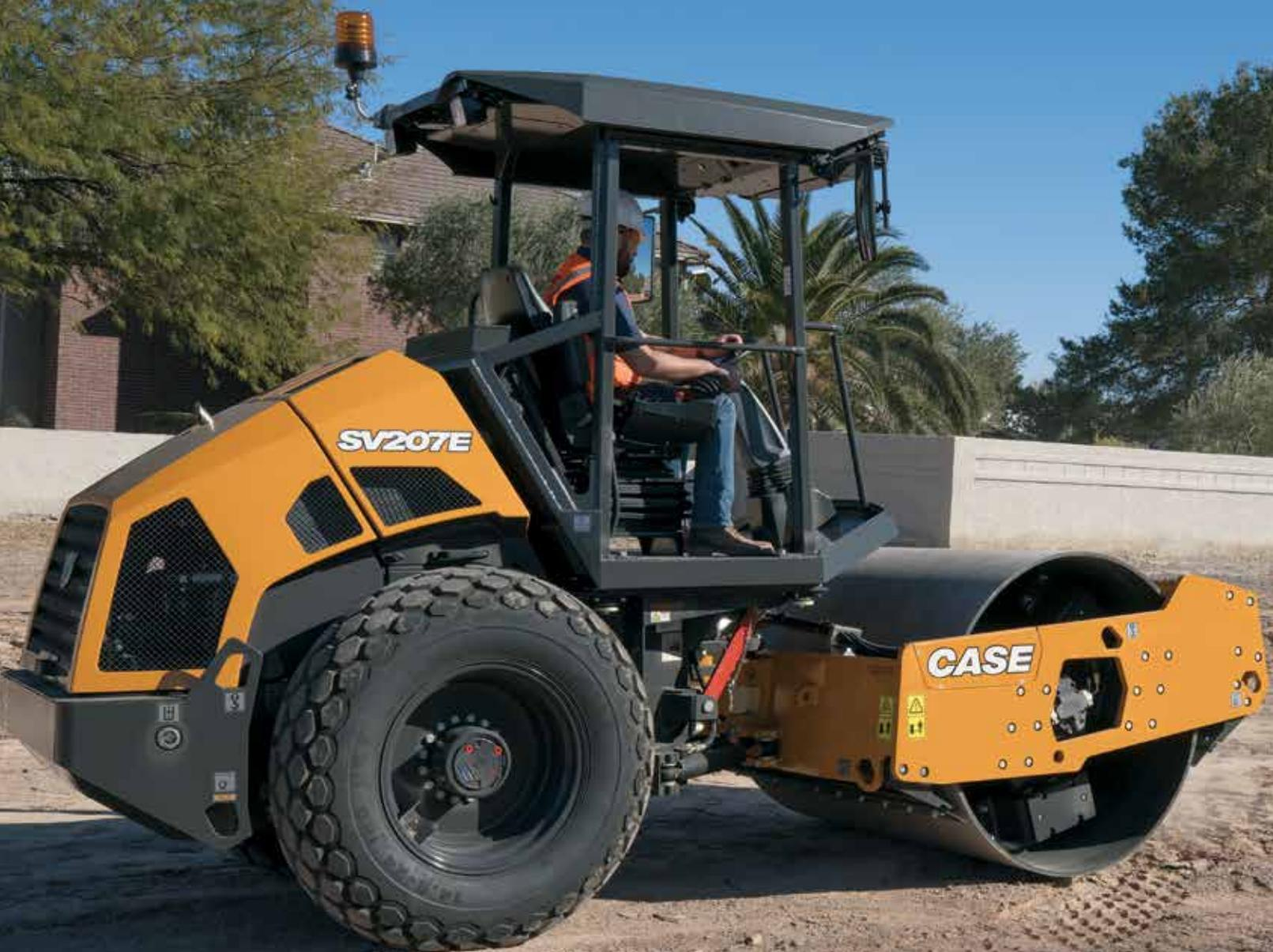
Le modèle SV207E est doté d'un tout nouveau châssis arrière et d'un rouleau de plus petit diamètre avec une coque plus épaisse qui améliore les performances globales, la souplesse, la visibilité, le rendement énergétique et le transport d'un site à l'autre.
