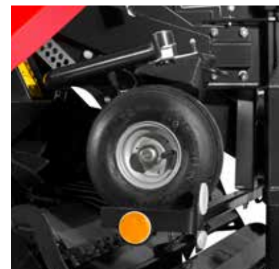
Pickup-Stützrad in Transportstellung
