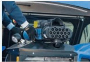
Der Luftfilter des Motors kann ohne Werkzeug und vom Boden aus kontrolliert, gereinigt und ausgetauscht werden.
