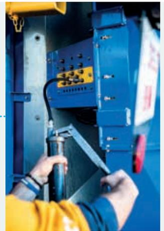
Alle Schmierpunkte am Erntekopf befinden sich an einem zentralen Punkt und sind leicht vom Boden aus zugänglich. Das erleichtert die Wartung und reduziert den Aufwand.
