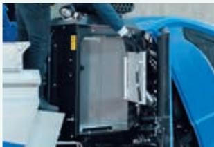
Die Kühleinheit ist zur einfacheren und schnelleren Reinigung ausschwenkbar.
