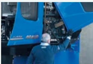
Die zweiteilige Motorhaube lässt sich weit öffnen und bietet ungehinderten Zugang zum Motorraum: Über die aufklappbare Fronthaube gelangt man zum Motor, während die Seitenklappe mit Gasdruckfeder zur Reinigung und Wartung von Hydraulik und Kühlern hochgeschwenkt werden kann.
