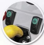
Los controles electrohidráulicos del bloqueo del diferencial y la doble Tracción están ubicados bajo el volante para un fácil acceso.
