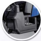
El tanque de combustible con capacidad de hasta 79 litros garantiza una excelente autonomía para trabajar de forma continua.
