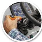
La palanca del inversor bajo el volante al lado izquierdo ofrece una fácil inversión del avance con 12 cambios de avance y 12 de reversa.
