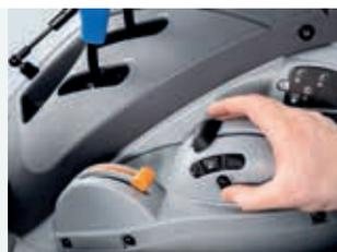
Les commandes du relevage électronique EDC sont judicieusement placées pour pouvoir ajuster la vitesse de descente, la hauteur, la sensibilité et le patinage pour un travail uniforme et une traction optimale.
