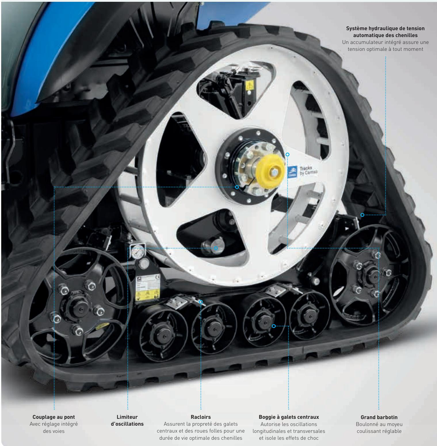
**Système hydraulique de tension automatique des chenilles**
