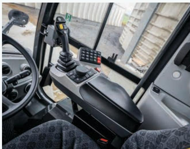
Os controlos estão estrategicamente agrupados ao alcance do joystick multifuncional, integrado no apoio de braços direito. O apoio de braços é montado no banco do condutor com suspensão pneumática, movendo-se perfeitamente consigo em terrenos irregulares para o máximo conforto.
