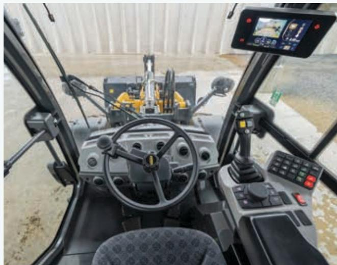
A cabina W100D redesenhada proporciona uma visão quase totalmente desobstruída de 360° graças à sua posição de condução elevada e à extensa superfície envidraçada entre quatro pilares estreitos. As portas de vidro de abertura ampla garantem um acesso fácil ao interior luminoso e arejado, com baixos níveis de ruído de 71 dBA.
