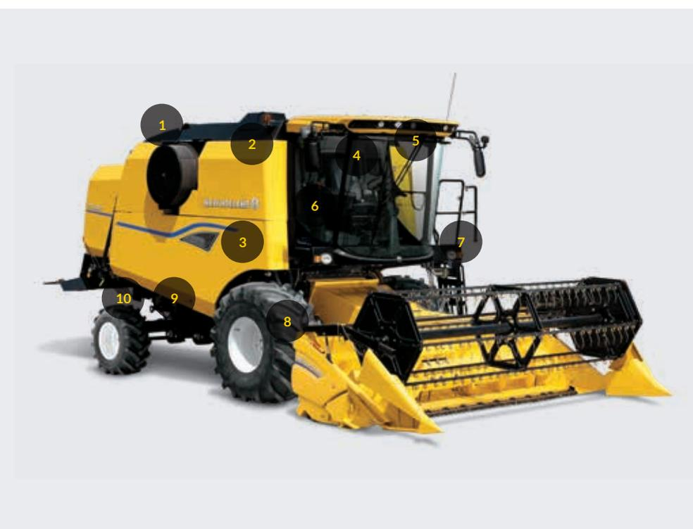
1. Motore Stage V da 175 CV, 4 cilindri
