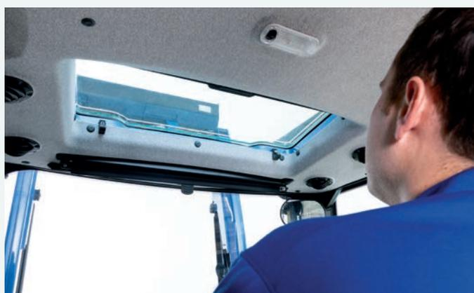
Un panneau à haute visibilité optionnel sur tous les modèles de cabine WORKMASTER<sup>MC</sup> offre une plus grande visibilité, surtout lorsque vous utilisez une chargeuse.
