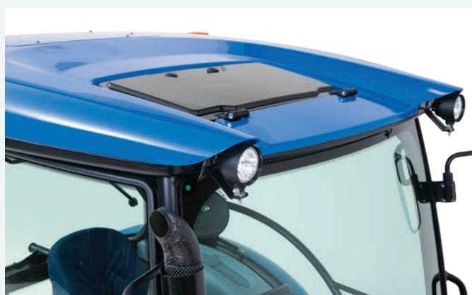
Le système de chauffage et de climatisation comprend six orifices d'aération sur le toit et une trappe avec vitre teintée qui s'ouvre si vous souhaitez plus de ventilation.
