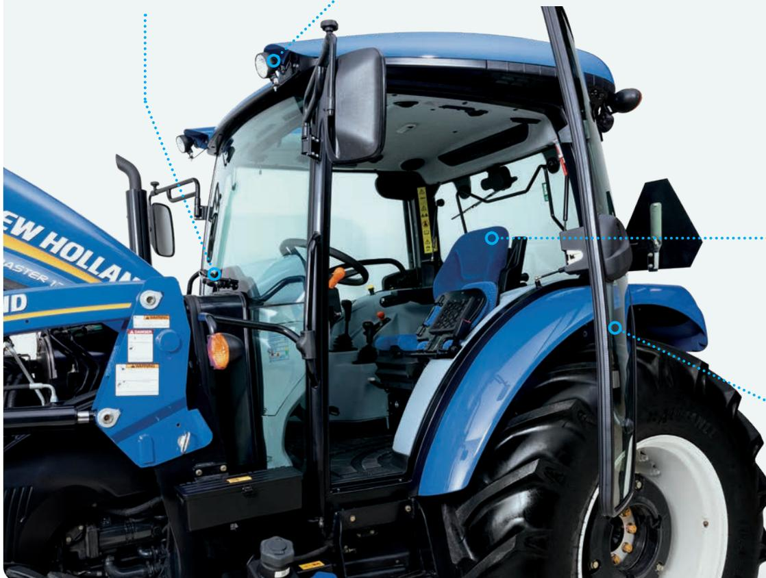
Profitez de sièges confortables pour deux personnes avec un **siège à suspension pneumatique en tissu** et un **siège d'instructeur** qui se replie pour du rangement supplémentaire
