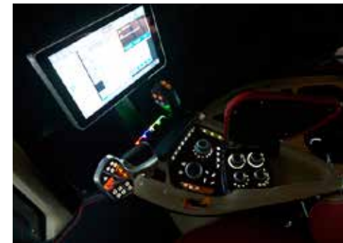
De symbolen op alle schakelaars hebben achtergrondverlichting wanneer de koplampen branden.
