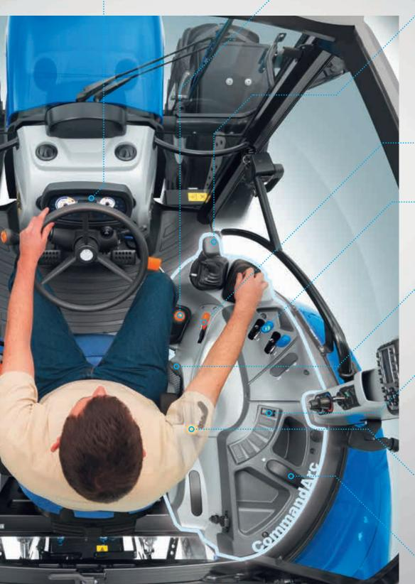
L'acceleratore elettronico permette di calibrare con precisione la velocità d'avanzamento del trattore.
