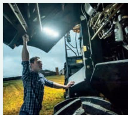
El conjunto de luces LED en las compuertas laterales facilita aún más las tareas de mantenimiento cuando ya no hay luz solar disponible.
