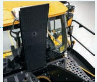
La amplia apertura de las protecciones laterales garantiza el acceso total a todos los mecanismos de transmisión y puntos de servicio.
