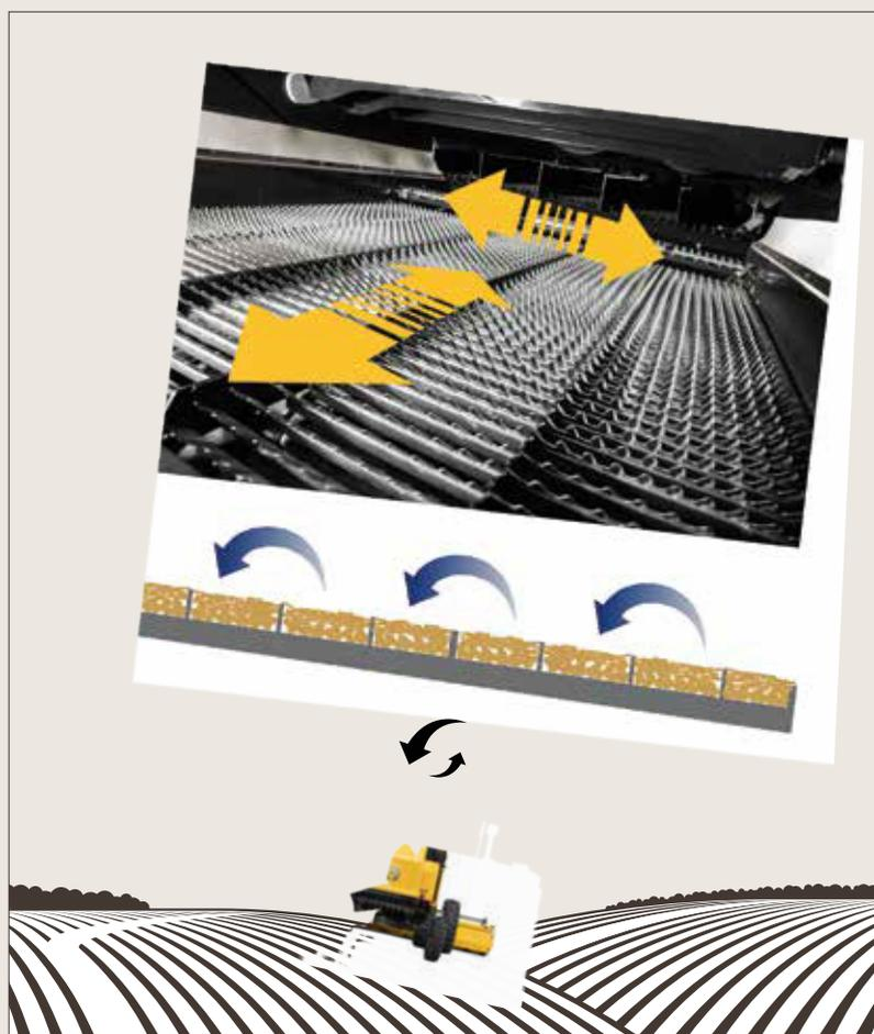
Por lo tanto, con el sistema de control automático de la velocidad del ventilador, el OptiFan, en combinación con SmartSieve, la línea TX es capaz de realizar una corrección automática del relieve del terreno en cualquier dirección, sin que el operador tenga que preocuparse por eso.
