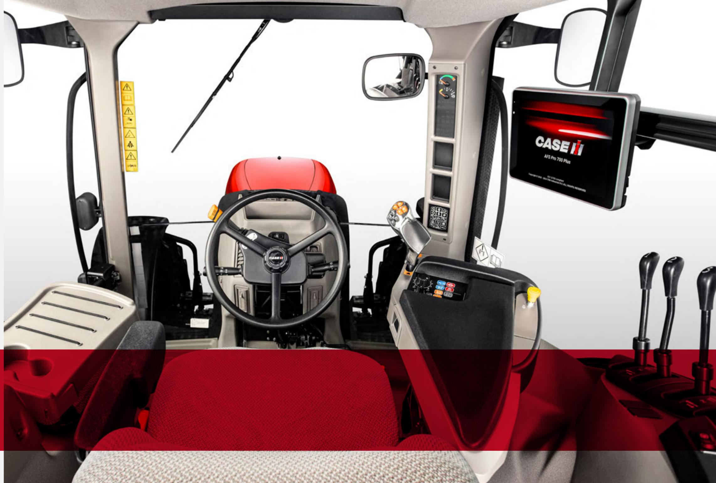
A alavanca multifunção foi projetada para se encaixar perfeitamente na mão direita do operador, proporcionando a ele conforto total na operação do trator e acesso às principais funções operacionais na ponta dos dedos.
