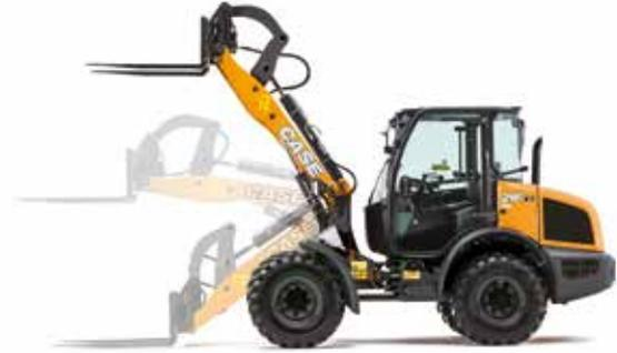
**Z-bar** es el tipo de cinemática más versátil. Ofrece una fuerza de arranque mayor gracias a los 2 cilindros de elevación y una altura de descarga más alta.
