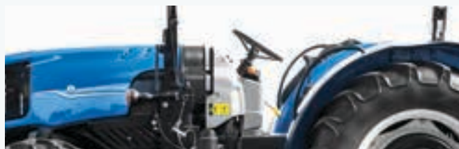
In het midden gemonteerde ROPS met gasveren zorgt voor makkelijk in- en uitklappen van het ROPS frame
