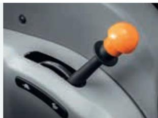
A alavanca de acionamento do super-reductor, posicionada ergonomicamente, adapta-se na perfeição à sua mão.
