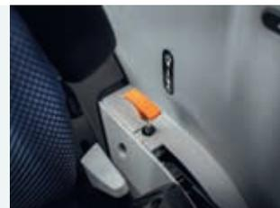
A alavanca da velocidade de deslocamento, ergonomicamente posicionada, fica naturalmente à mão.
