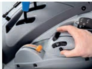
Os comandos EDC avançados estão perfeitamente posicionados para personalizar a velocidade da descida, o limitador de altura, a sensibilidade e a patinagem, de modo a proporcionar um cultivo uniforme e a máxima tração.
