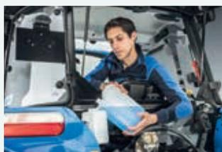
Encha o depósito de limpeza do para-brisas através da janela traseira.
